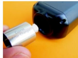
Удерживая инструмент за сторону без прорезей, аккуратно введите его в корпус прямо без наклона. Поверните инструмент по часовой стрелке. Поначалу вы почувствуете легкое сопротивление. Продолжайте крутить инструмент пока фильтр не начнет проскальзывать внутри. (Фильтр перестанет крутиться, а инструмент еще можно прокрутить.) Вытащите инструмент.
